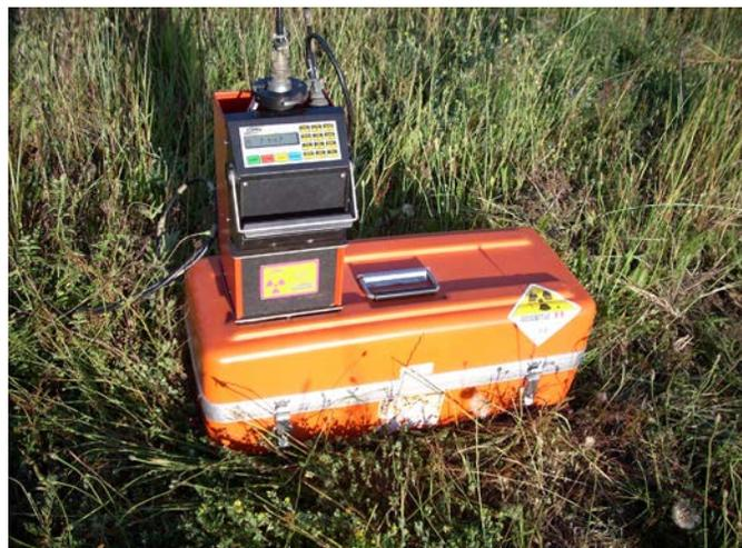
**Figura 1 . Sonda de neutrones CPN 503-DR Hydroprobe en posición de conteo estándar y medición en el suelo.**
