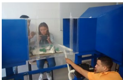
Imagen 7. Análisis del flujo de viento con el túnel de viento en la asignatura proyecto III de la Universidad de la Costa (fuente: El autor, 2018).
