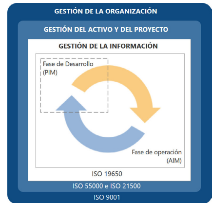
Figura 2. Ciclo de vida de la gestión de la información de los proyectos y activos según EN19650:2019 (fuente: Elaboración propia, 2021).
