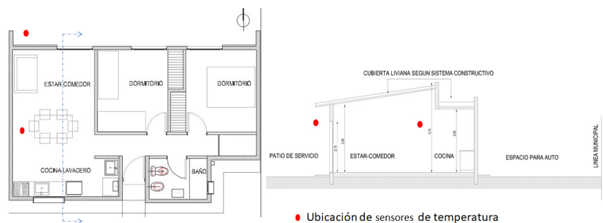
Figura 2. Planta tipo, corte y ubicación de los sensores de temperatura (fuente: IPV y elaboración propia, 2023).
