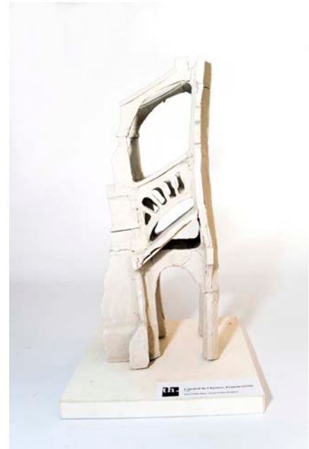
Imagen 1. Sección de la nave lateral y el arbotante de la catedral de Nuestra Señora de Chartres, escala 1:100. La maqueta construida en yeso sufrió una serie de deformaciones que guardan similitudes con los modelos de análisis estructural de elementos finitos. Grupo: Diego González, Paulina Orellana (fuente: María Cirano).
