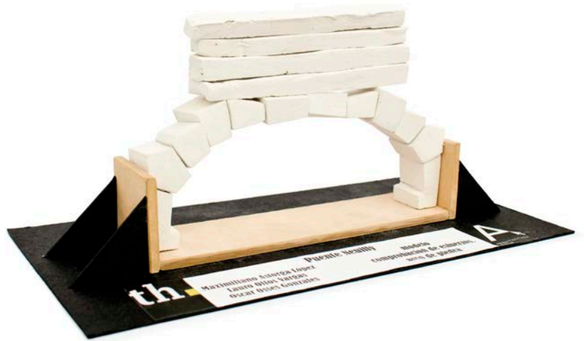
Imagen 14. Modelo físico del arco carpanel del puente de Neully. Grupo: Maximiliano Astorga, Lauro Olfos, Oscar Osses (fuente: María Cirano).
