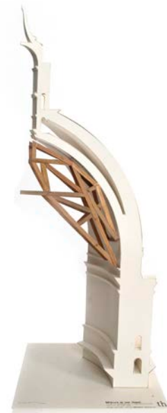
Imagen 2. La maqueta representa el hipotético sistema de andamiaje apoyado en el tambor de la cúpula de San Pedro de Roma, escala 1:100. Grupo: Pilar Aguilar, Camila Baquedano, Daniela Gil (fuente: María Cirano).
