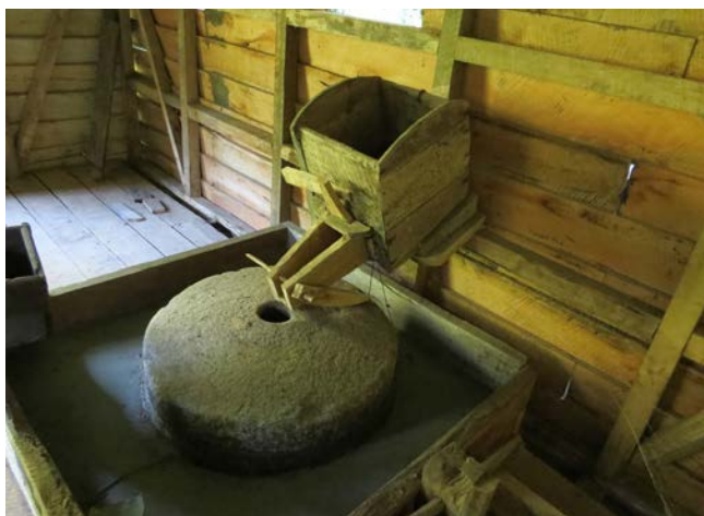
Imagen 3. Piedra circular llamada "encimera", que gira sobre la piedra fija a la camada, conocida como "abajera" o solera. La fricción de ambas convierte el grano en harina (fuente: José Bravo 2014).
