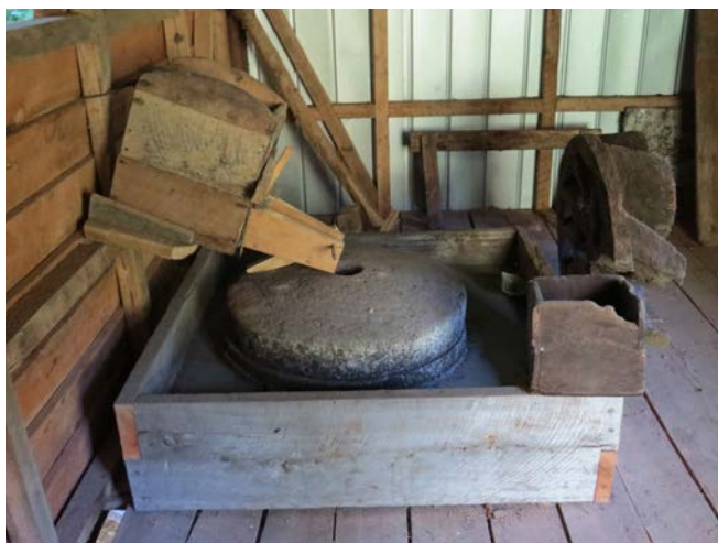
Imagen 1. Artefactos propios de la molienda: tolva, piedras de moler o muelas, camada y almud maquillero (fuente: José Bravo 2014).
