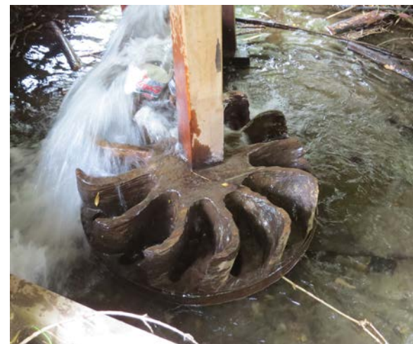
Imagen 10. Rodezno de madera haciendo girar la maquinaria molinera gracias a la fuerza del agua (fuente: José Bravo 2014).
