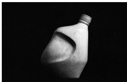
Imagen 8. Molde de madera para la Botella de Aceite Chef (1970) utilizado para el proceso de termo formado (fuente: Archivo Histórico José Vial Armstrong e[ad] PUCV, 1970).
