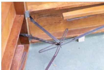
Imagen 15. Sistema de flejes metálicos de la mesa de ping-pong (1965) (fuente: cortesía de Diego Cruz, 2022).
