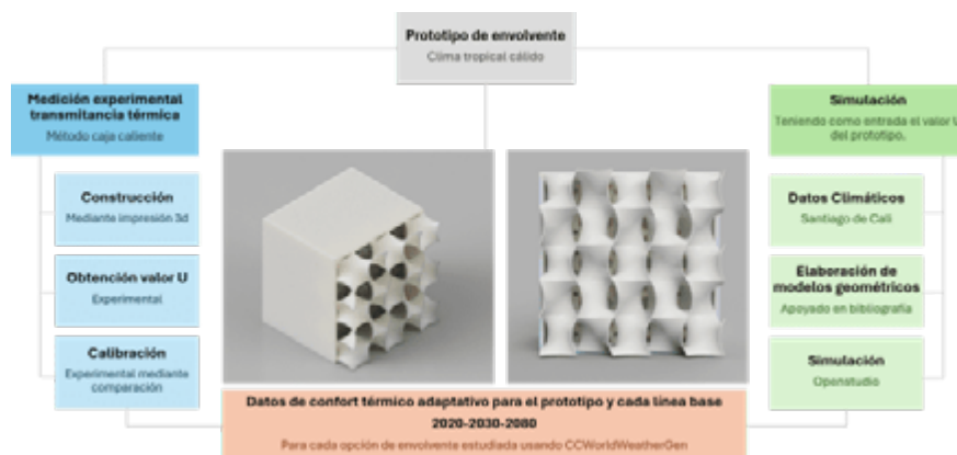
Figura 1. Esquema del proceso de validación del prototipo bioclimático y simulación energética. Se modeló el confort adaptativo con base en datos climáticos históricos y proyectados (fuente: elaboración propia, 2025).
