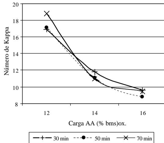
Figura 3. Efecto de la carga de álcali activo y tiempo a T<sub>máx</sub> sobre el número de Kappa.
