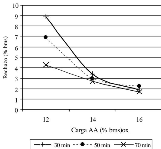
Figura 2. Efecto de la carga de álcali activo y tiempo a T<sub>máx</sub> sobre la obtención de rechazo.
