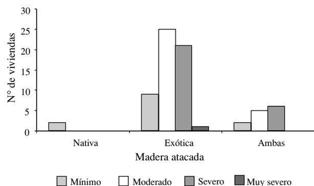
**Figura 2.** Origen de la madera de construcción y niveles de deterioro en viviendas de Padre Las Casas (La Araucanía, Chile).
