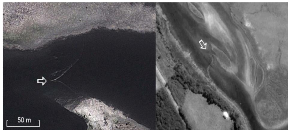
Figura 11. Comparación de corrales asociados a nasas. Izquierda, ambiente fluvial: río Itata, región del Maule. Derecha: ambiente marino: Isla Guar, región de Los Lagos. Las flechas indican abertura de corral donde se instala la nasa
